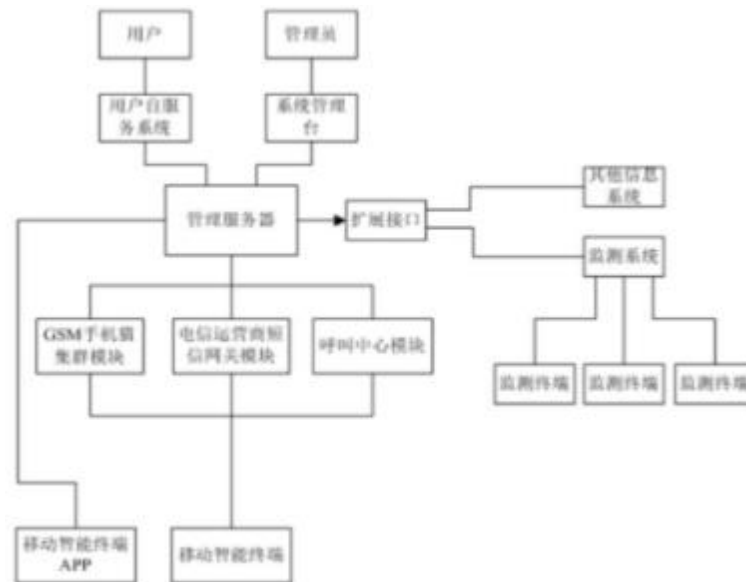
图1 基于移动智能终端的应急通信系统的架构示意图
