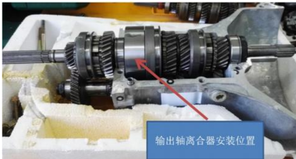
图3 输出轴离合器式变速箱样机
